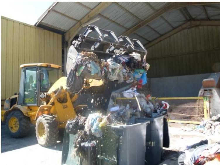
Echantillonnage par tirage au sort aléatoire de bacs de prélèvements (4 échantillons de 50 kg) Crédits : SARL Verdicité
